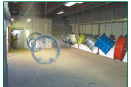
Cabine de peinture et séchage
